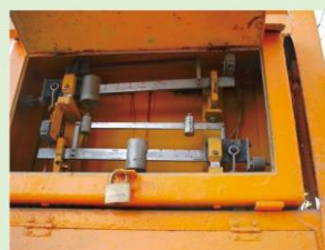
従来型計量器の調整箇所
