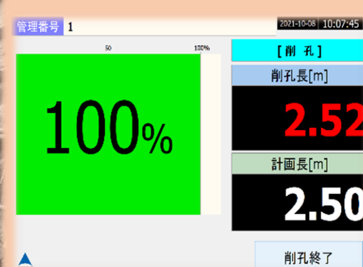
削孔時に自動でリアルタイム計測
