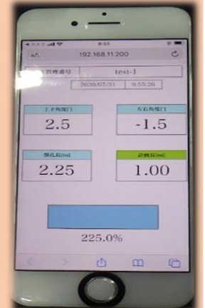
削孔時に自動でリアルタイム計測
